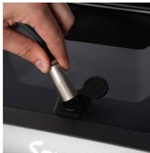
**⚠️ El scooter cuenta con una función automática para evitar que se encienda durante la carga. Después de cargarlo, es importante apagar primero el interruptor de alimentación y luego desconectar los otros enchufes.**
