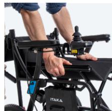
Infine, abbassare completamente i poggiatesta. Una volta in posizione, abbassare le piattaforme dei poggiatesta. Ora la sedia iTaka sarà completamente pronta per l'uso.
