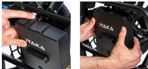
**Prima di montare la batteria, assicurarsi di allineare il cilindro dietro la scatola della batteria con il foro nel supporto della batteria, che consente di fissare facilmente la batteria in posizione.**
