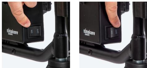
**Troca de bateria:** se a sua cadeira iTake estiver equipada com duas baterias, utilize o botão abaixo para selecionar qual pretende utilizar. Pressione o botão **"II"** para ativar a bateria esquerda e **"I"** para a bateria direita.
