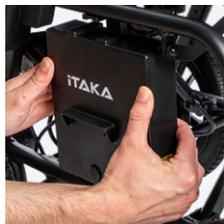
**Antes de montar a bateria, certifique-se de que alinha o cilindro atrás da caixa da bateria com o orifício no suporte da bateria, o que pode facilmente fixar a bateria no lugar.**
