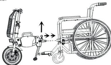
Tenere premuto il pulsante rosso per sollevare le ruote anteriori della sedia a rotelle ad un'altezza adeguata da terra. Il pulsante verde si abbassa e solleva il perno di bloccaggio per uscire dalla connessione.
