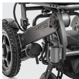
Novo sistema de fácil acesso para ligar/desligar o motor
