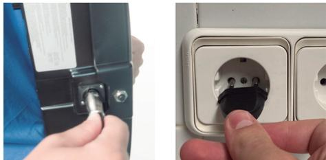
Ao desligar a ficha, certifique-se de remover primeiro o cabo de parede AC e depois o cabo de saída do carregador da porta de carga.
