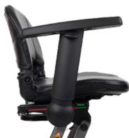
Quando se roda o apoio de braço para trás, este não se encontra na posição bloqueado. Mova o apoio de braço para a posição original para o bloquear.
