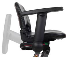
**Quando o apoio de braço é empurrado para trás, ainda não está na posição de bloqueio. Para o trancar, o apoio de braço deve ser devolvido à sua posição original.**
