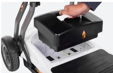
Por qualquer razão para remover a caixa da bateria, certifique-se de que os conectores estão em sequência e em posição quando voltar a montar a scooter.
