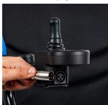
Retire el cargador cuando la batería esté completamente cargada.
