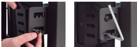
**Para ajustar la inclinación**, desatornille únicamente el tornillo inferior de los dos utilizando una llave allen. Desplace la placa de montaje al siguiente orificio y, luego, reinserte y apriete el tornillo con la misma llave.
