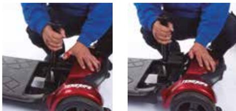
**Montaje:** sujete el soporte del asiento y mueva la sección trasera hacia delante hasta que la palanca quede asegurada. Gire la sección trasera hasta que esté vertical.
