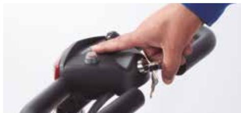
**Palancas de control de conducción:** actuando la palanca de la derecha el scooter irá hacia delante y actuando en la de la izquierda lo hará hacia atrás. Si dejamos ambas se activa el freno. Funciona además como acelerador ya que cuando más presione la barra más rápido irá.
