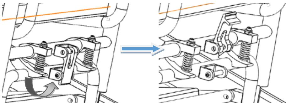
**Paso 2:** Comprima el tubo del respaldo como se muestra en la Imagen 2 para plegarlo completamente.
